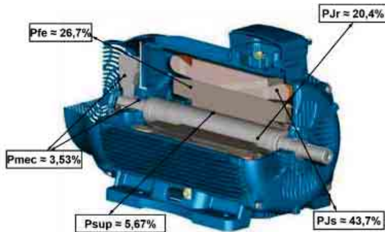
Répartition des pertes d'un moteur WEG W22 P = 30 kW, 4 pôles, IE4
